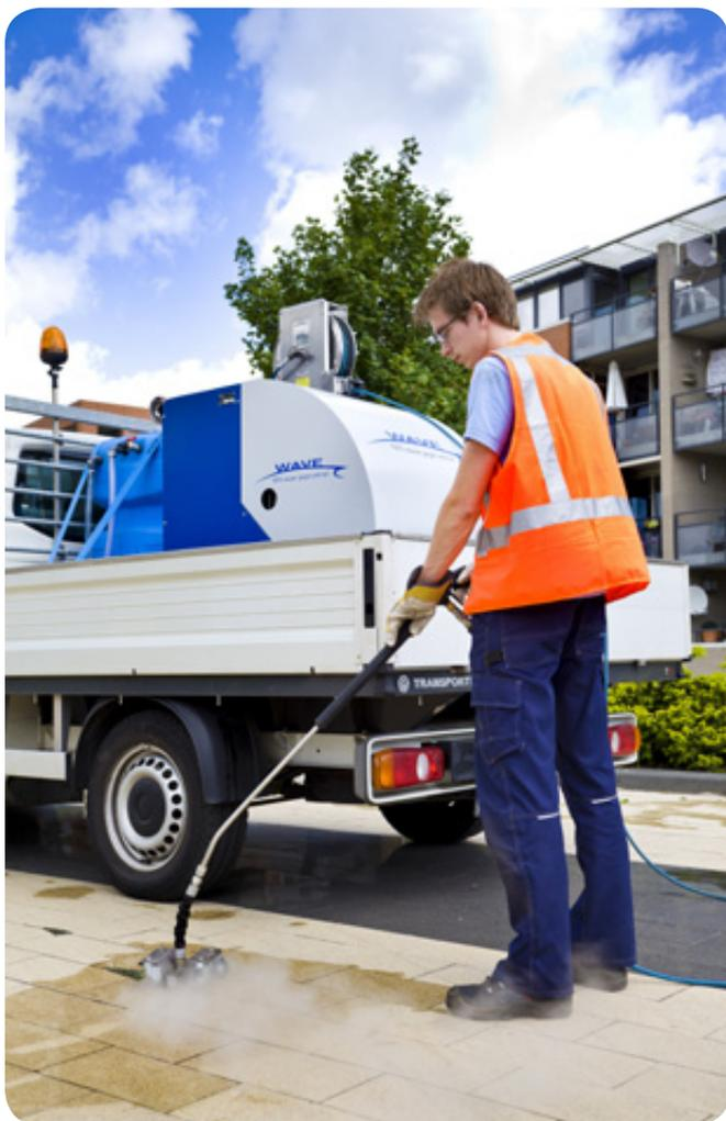
**Kompakte Wildkrautbekämpfung mit der WAVE Mid Series mit einer Flächenleistung bis zu 2.500 qm pro Tag**
