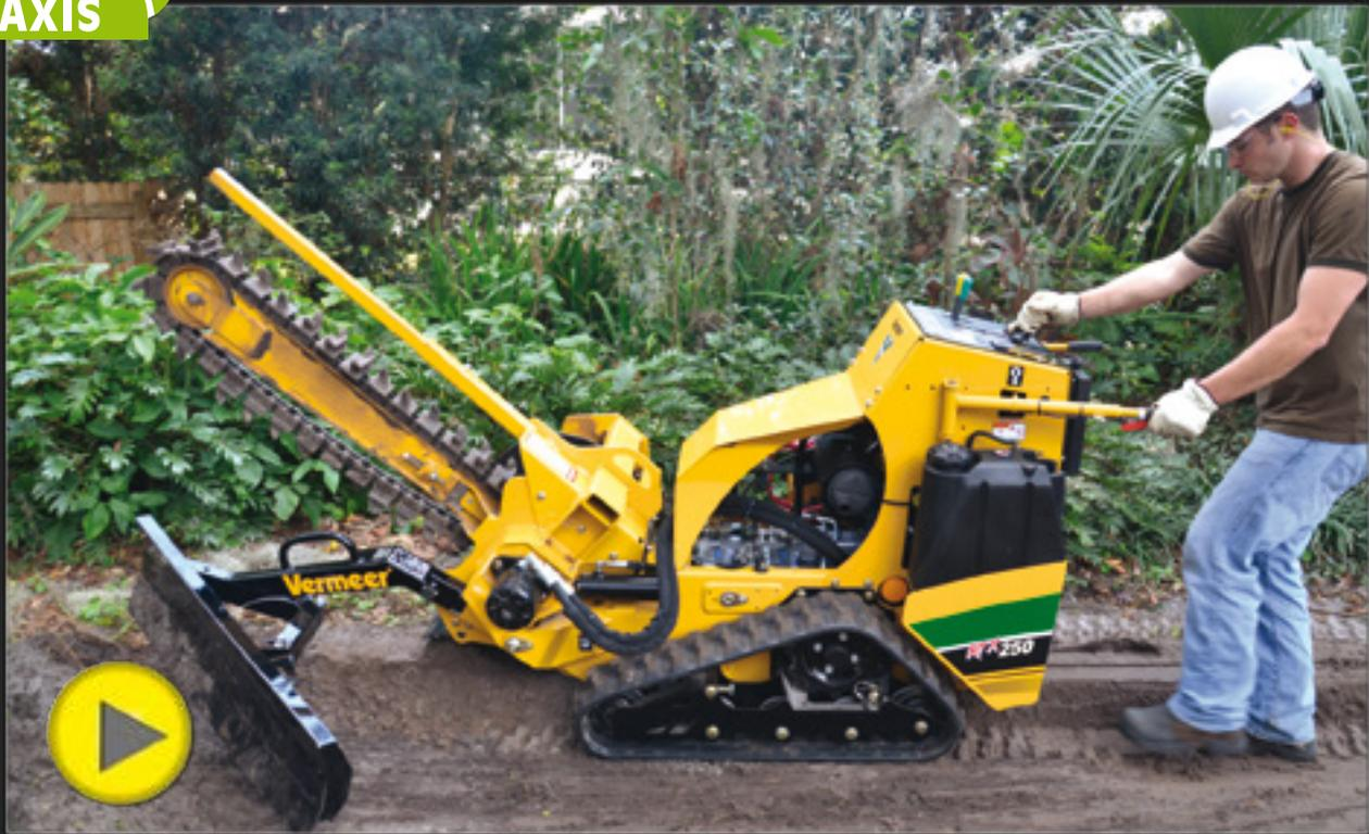
Die neueste handgeführte Mobilfräse von Vermeer ist eine leistungsstarke und wartungsfreundliche Maschine, die sich durch hohe Produktivität auszeichnet. Die RTX250 ist mit einem 20,1 kW (27 PS) Kohler Benzin-Motor mit elektronischer Kraftstoffeinspritzung versehen und bietet eine Frästiefe von 122 cm und eine Fräsbreite von bis zu 20 cm. Dank ihres schlanken Profils kann die Maschine problemlos durch schmale Gartentore gefahren werden.
