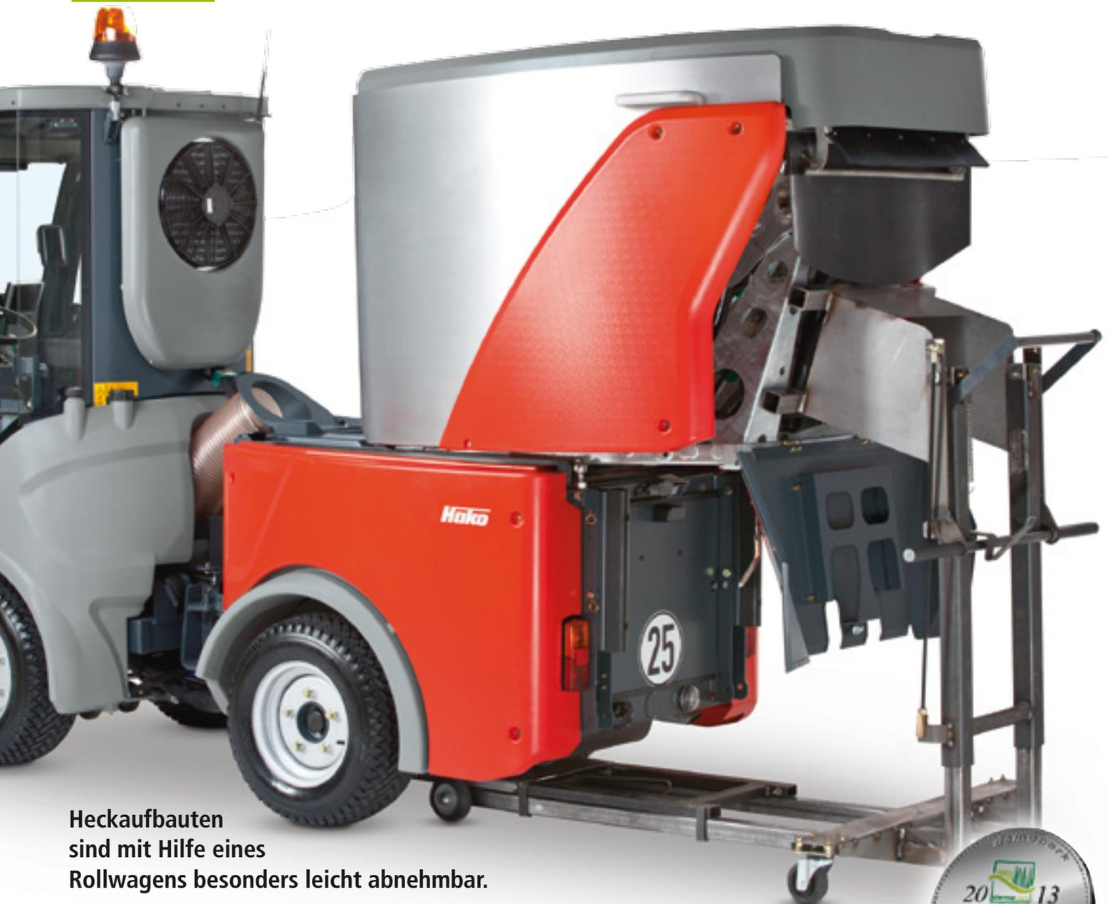
Heckaufbauten sind mit Hilfe eines Rollwagens besonders leicht abnehmbar.
