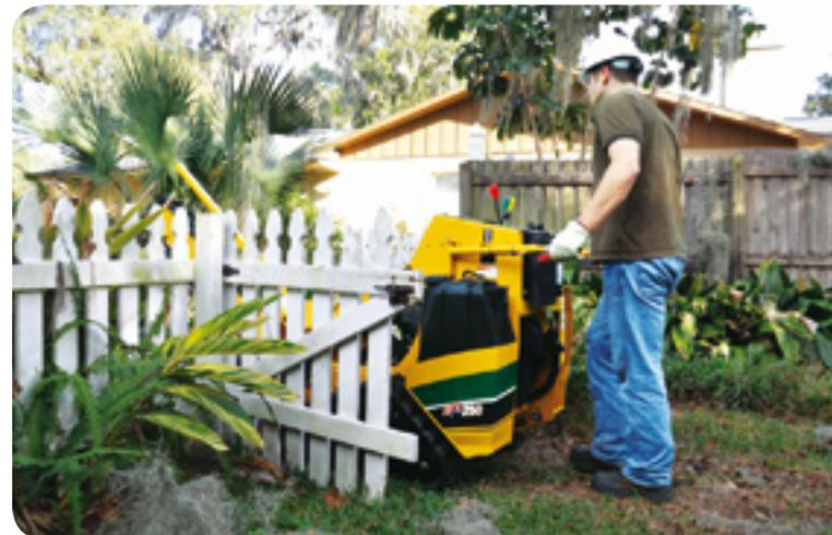
chem Fahrtrieb bietet die RTX250 mehr Flexibilität und Vielseitigkeit. Gummiraupenfahrwerke ermöglichen hervorragende Traktion in weichen, steinigen oder schlammigen Böden und gewährleisten eine minimale Bodenbeanspruchung. Ein „werkzeugloser“ Zugang zu allen täglichen und wöchentlichen Servicepunkten reduziert den Wartungsaufwand und die Wartungszeit. (am) ■
